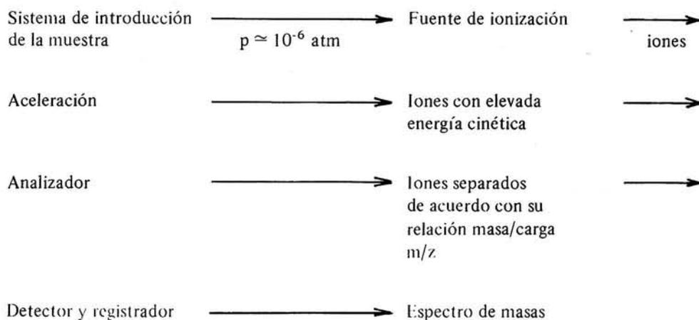
La muestra, sólida o líquida, debe ser vaporizada antes de llegar a la fuente de ionización. Puede ser introducida mediante un cromatógrafo gas-líquido (C.G.L.), por lo que podemos separar y analizar los componentes de una mezcla en un tiempo muy breve. Esta combinación CGL-EM es una de las herramientas analíticas más poderosas con que se cuenta en la actualidad.
